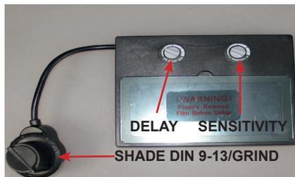
**SHADE** - zatmavenie filtra **DIN 9-13** je nastaviteľné otočným ovládačom na ľavej strane kukly. Správnu hodnotu **DIN** nastavte podľa metódy a zväracieho prúdu. Hodnoty nastavenia sú uvedené v tabuľke. Pre brúsenie pretočte ovládač do polohy **GRIND**.
